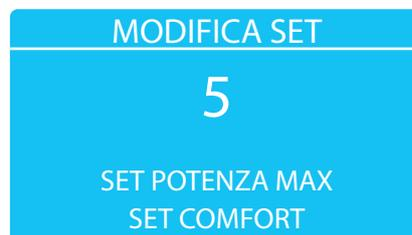
Usare il tasto **P4** per passare da temperatura a potenza manuale e viceversa, usare **P5/P6** per modificare i valori.
