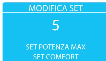
Usare il tasto **P4** per passare da temperatura a potenza manuale e viceversa, usare **P5/P6** per modificare i valori. Premere **P4** per almeno un secondo per confermare le modifiche ed uscire.
