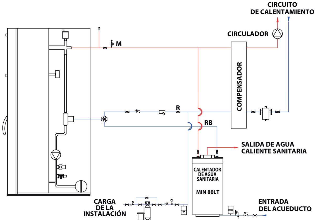
**ESQUEMA DE CONEXIÓN A UNA INSTALACIÓN DE CALENTAMIENTO Y PRODUCCIÓN DE AGUA CALIENTE SANITARIA**
