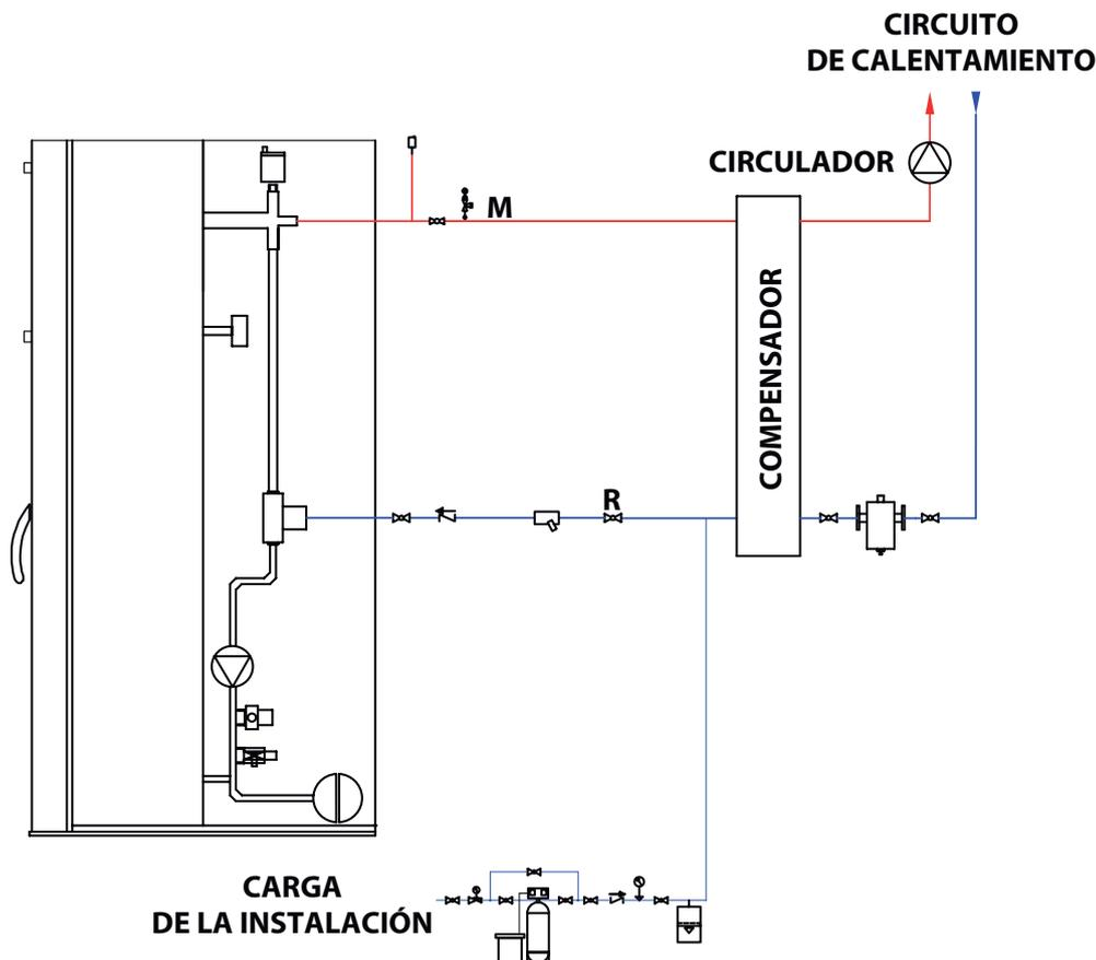
**ESQUEMA DE CONEXIÓN A UNA INSTALACIÓN DE CALENTAMIENTO Y PRODUCCIÓN DE AGUA CALIENTE SANITARIA**
