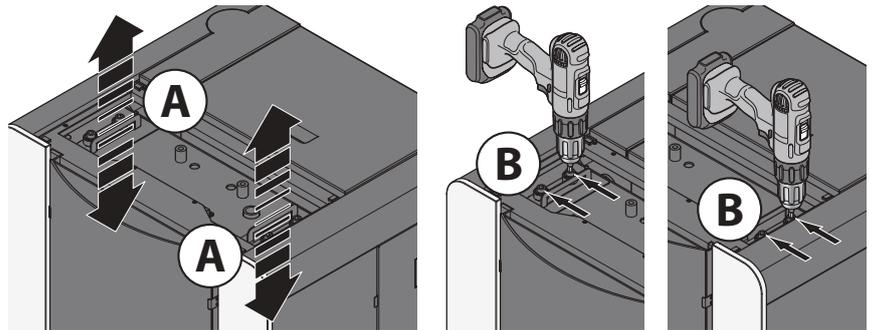
Compruebe y limpie del conducto de descarga de pellet.
