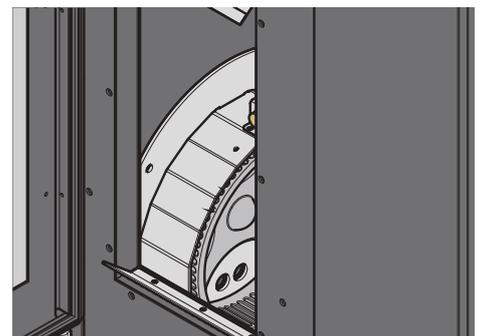
Los restos no quemados que están en el interior del sombrerete (7), además de ser aspirados, pueden hacerse caer con el rascador (8) en el fondo, donde después se llevarán al cajón de recogida de cenizas. Una vez acabadas las operaciones de limpieza, se puede volver a montar la tapa del quemador y volver a cerrar el conjunto efectuando las operaciones al revés.
