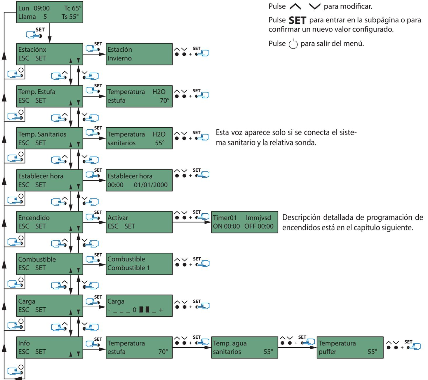
El menú "Carga" permite variar la cantidad de caída del combustible y está dividido en 3 niveles de aumento (+) y 3 niveles de disminución (-) igual cada uno a 0,2 segundos para un total de +/- 0,6 segundos. Esta variación permanece constantemente en la memoria y se asocia simultáneamente a todas las seis potencias de funcionamiento.
